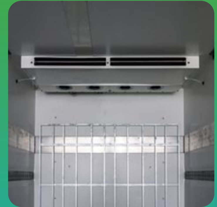
Kryogener Wärmetauscher mit Ventilatoren
