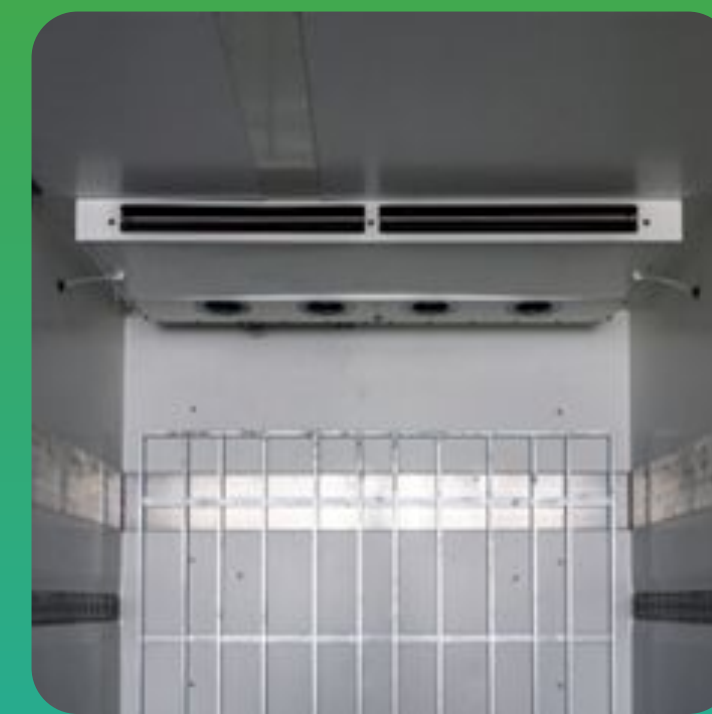
Échangeur de chaleur cryogénique avec ventilateurs
